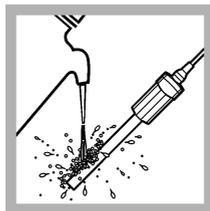
3. Enjuague la sonda con agua desionizada. Seque la sonda con un trapo que no deje pelusas.
