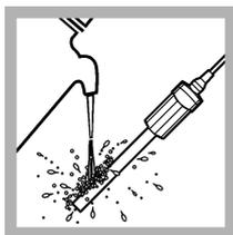
2. Enjuague la sonda con agua desionizada. Seque la sonda con un trapo que no deje pelusas.
